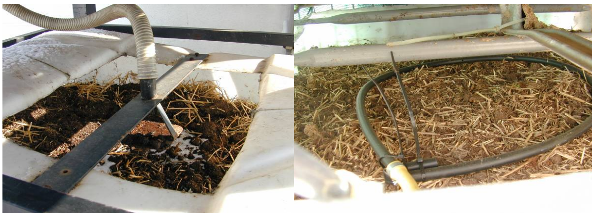
Fig. 21 & 22: Verspreiding van de gecontamineerde vloeistof over het oppervlak van het biozuiveringssysteem dmv een metalen plaat (links, Bron: CRAw) of een circulair geperforeerde slang (rechts, Bron: pcfruit vzw).
