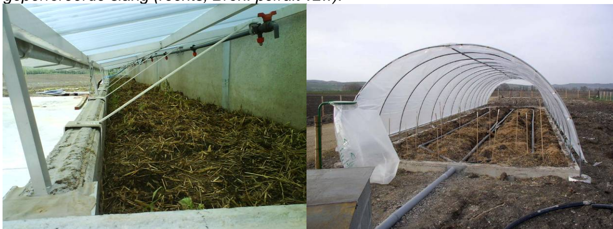
Fig. 23 & 24: Verspreiding van de gecontamineerde vloeistof over het oppervlak van het biozuiveringssysteem dmv spuitdoppen (links, Bron: POVLT) of geperforeerde leidingen (rechts, Bron: Bayer CropScience).
