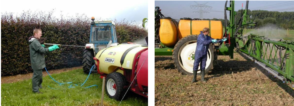
Fig. 8 & 9: Reiniging van de buitenkant van een boomgaardspuit (Bron: pcfruit) en een veldspuit (Bron: LWK-NRW)
